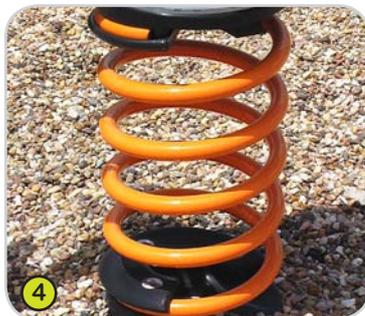
4- Le **molle** sono in acciaio 35SCD6. La superficie viene trattata dopo la granigliatura di precompressione e rivestita con protezione allo zinco e 2 strati di polvere epossidica di poliestere di 100 micron. Il supporto di sostegno (Brevetto Proludic) in poliammide rinforzata garantisce una conservazione e una sicurezza eccezionale al sistema.
