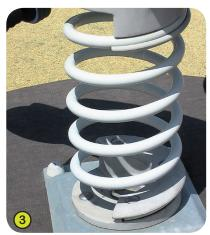
**3- Le molle** sono in acciaio 35SCD6. La superficie viene trattata dopo la granigliatura di precompressione e rivestita con protezione allo zinco e 2 strati di polvere epossidica di poliestere di 100 micron. Il supporto di sostegno (Brevetto Proludic) in poliammide rinforzata garantisce una conservazione e una sicurezza eccezionale al sistema.
