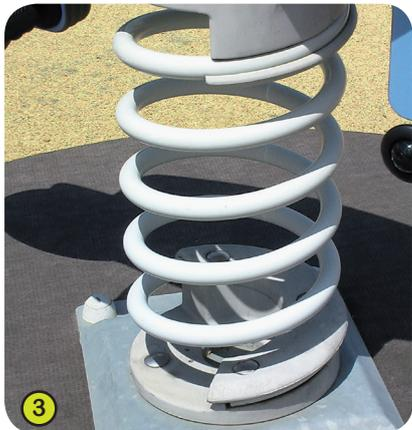
3- Le **molle** sono in acciaio 35SCD6. La superficie viene trattata dopo la granigliatura di precompressione e rivestita con protezione allo zinco e 2 strati di polvere epossidica di poliestere di 100 micron. Il supporto di sostegno (Brevetto Proludic) in poliammide rinforzata garantisce una durata e una sicurezza eccezionale al sistema.
