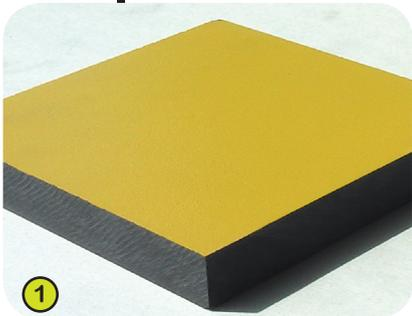
1- I **pannelli colorati** sono in HPL spessore 13 mm, costituiti unicamente da materiali a base di cellulosa (70%) e resine termoindurenti (30%), vantano eccezionali caratteristiche di resistenza meccanica, fisica e chimica e grande semplicità di manutenzione.
