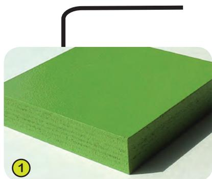
1- I **pannelli** sono in legno multistrato di spessore 22 mm, con 15 strati di betulla alternati e contrapposti. La colorazione con polverizzazione elettrostatica di vernice poliuretanica bicomponente priva di metalli pesanti assicura un'elevata capacità di resistenza ai potenziali agenti chimici, come per esempio i prodotti per la manutenzione anti-graffiti.
