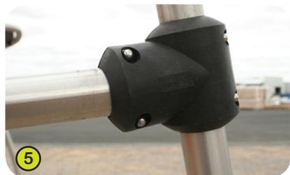
5- I **tubi** sono in acciaio INOX di Ø 40 mm che garantisce longevità ed estetica del gioco nel corso degli anni. I **pezzi di giunzione** sono stampati in poliammide caricata, sono atossici ed ininfiammabili, resistenti agli urti e ai raggi ultravioletti, assicurano robustezza del gioco e resistenza contro gli atti di vandalismo.
