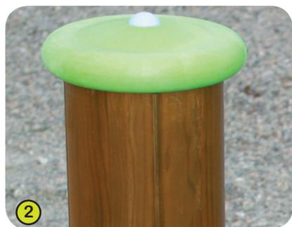
2- I **pali portanti a pianta circolare** da 125 mm sono in pino lamellare incollato trattato senza cromo né arsenico. Ciò previene il legno dall'attacco di funghi, insetti e termiti. Senza schegge, con scanalature verticali sui quattro lati, il lamellare incollato garantisce grande solidità e stabilità dimensionale. Coperchi di protezione in poliammide proteggono i pali dalle intemperie e dalle infiltrazioni.
