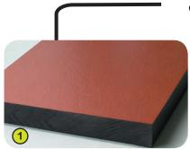
1- Le placche colorate sono elaborate a partire da un materiale compatto spesso 13 mm. Composto per il 70% in fibre di legno tenero e per il 30% in resina termoindurente, presenta un'ottima resistenza alle intemperie (sole, pioggia, umidità...).
