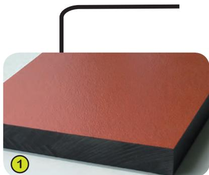
1- **Le placche colorate** sono elaborate a partire da un materiale compatto spesso 13 mm. Composto per il 70% in fibre di legno tenero e per il 30% in resina termoindurente, presenta un'ottima resistenza alle intemperie (sole, pioggia, umidità...).
