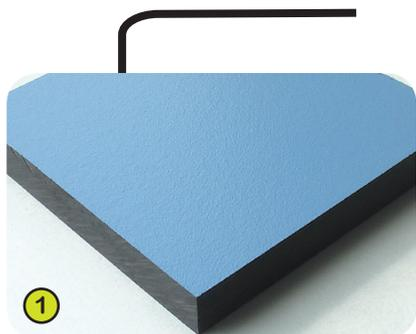
1- **Le pannellature colorate** sono elaborate a partire da un materiale compatto spesso 13 mm. Composto per il 70% in fibre di legno tenero e per il 30% in resina termoindurente, presenta un'ottima resistenza alle intemperie (sole, pioggia, umidità...).
