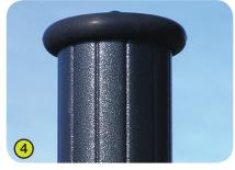
**4- I montanti portanti con un diametro di 125 mm** sono in acciaio galvanizzato verniciato, che garantisce la longevità e la robustezza dei giochi. I coperchi sono in poliammide iniettata.
