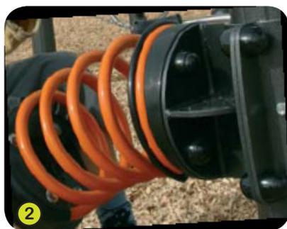
**2- Le molle** sono in acciaio 35SCD6. La superficie è trattata dopo la granigliatura di precompressione e rivestita con appretto zinco e 2 strati di polvere epossidica di poliestere di 100 micron. La base di sostegno della molla (Brevetto Proludic) in poliammide caricata garantisce una conservazione e una sicurezza eccezionale al sistema.
