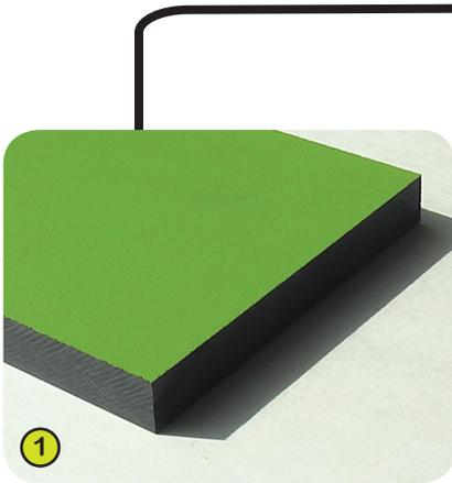
**1- Los tableros** se fabrican con HPL (Laminado Alta Presión) de 13 mm de espesor. Compuesto en un 70% de fibras de madera blanda y un 30% de resina termoendurecible, presenta una excelente resistencia contra las inclemencias del tiempo (sol, lluvia, humedad...). Los paneles de color se tratan a base de resinas acrílicas de poliuretanos pigmentados, lo que le garantiza una buena resistencia contra los rayos UV y las degradaciones.
