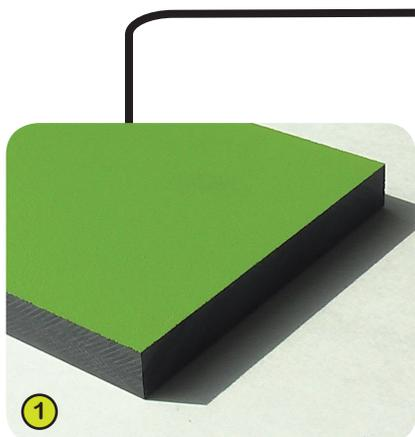
**1- Le pannellature colorate** sono elaborate a partire da un materiale compatto spesso 13 mm. Composto per il 70% in fibre di legno tenero e per il 30% in resina termoindurente, presenta un'ottima resistenza alle intemperie (sole, pioggia, umidità...). Le facciate colorate vengono trattate con resine acriliche poliuretatiche pigmentate, che garantiscono una buona tenuta ai raggi UV e alla degradazione. La personalizzazione del pannello è stampata e protetta da una vernice ad alta resistenza.
