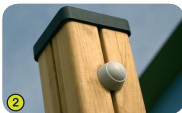
2- **I montanti a sezione quadrata da 95 x 95 mm** sono in pino lamellare incollato trattato in autoclave senza cromo né arsenico. Ciò previene il legno dall'attacco di funghi, insetti e termiti. Senza schegge, con scanalature verticali sui quattro lati, il lamellare incollato garantisce grande solidità e stabilità dimensionale.
