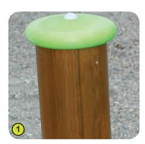
1- I pali portanti a pianta circolare da 125 mm sono in pino lamellare incollatotrattato senza cromo né arsenico. Ciò previene il legno dall'attacco di funghi, insetti e termiti. Senza schegge, con scanalature verticali sui quattro lati, il lamellare incollato garantisce grande solidità e stabilità dimensionale.
