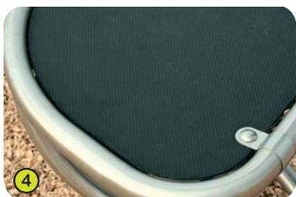
4- I pianali "Durax" sono fabbricati con pannelli di compensato da 22 mm composti da strati sottili di betulla e ricoperti in superficie da una pellicola di poliolefina termoplastica con rilievo antiscivolo e profilati da un tubo in inox da Ø 40 mm.
