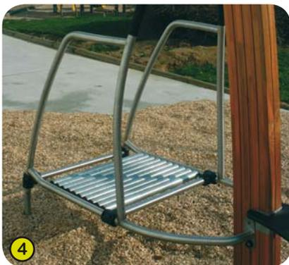
4- **Il tapis roulant**, interamente in inox, è fissato ad una trave curva in lamellare incollato, lungo mt 3,20 e di sezione 200 x 95 mm. La superficie della piattaforma, leggermente inclinata per facilitare il passo, è costituita da tubi ruotanti che accompagnano il movimento.
